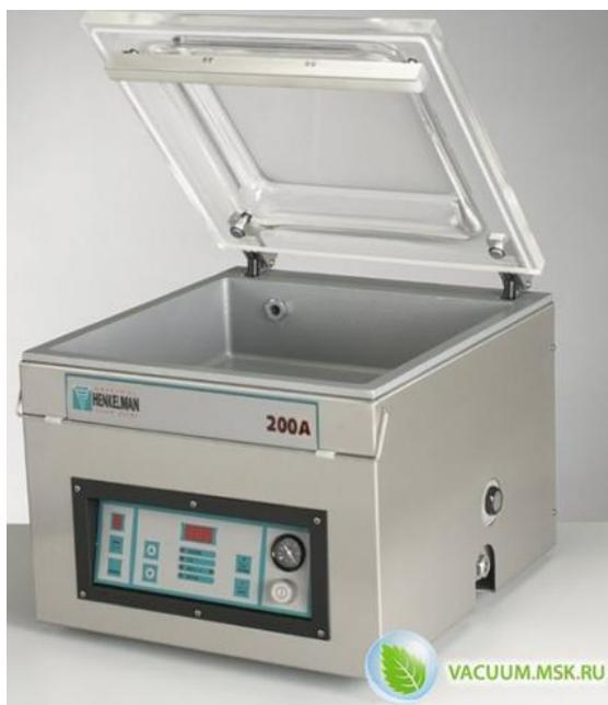
Вакуумный упаковщик HENKELMAN 200 A идеален для небольших производств. Используется для вакуумной упаковки пищевых продуктов. Расчитан на 8 часовую рабочую смену.
