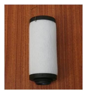
Фильтр масляно-воздушный для вакуумного насоса BUSCH PB 0016 (B,D) длиной 119 мм и диаметром 53 мм. Находится внутри вакуумного насоса. Отделяет масло от воздуха, предохраняет возникновение масляного тумана на выходе из насоса. Очищает масло от микрочастиц.
