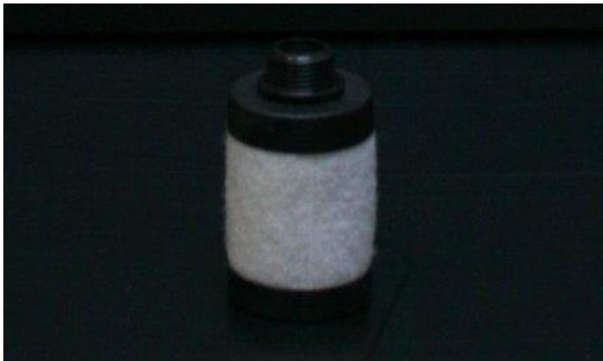
**Фильтр масляно-воздушный для вакуумного насоса BUSCH PB 0004 (A,B)** длиной 55 мм и диаметром 34 мм. Находится внутри вакуумного насоса. Отделяет масло от воздуха, предохраняет возникновение масляного тумана на выходе из насоса. Очищает масло от микрочастиц.
