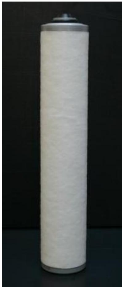
**Фильтр масляно-воздушный для вакуумного насоса BUSCH RA 0160 D** длиной 375 мм и диаметром 72 мм. Находится внутри вакуумного насоса. Отделяет масло от воздуха, предохраняет возникновение масляного тумана на выходе из насоса. Очищает масло от микрочастиц.
